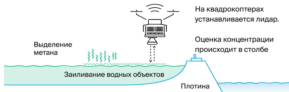
Инструментальные замеры поглощающей способности и выбросов углеродных единиц (в кг) малогабаритной установкой, прикрепленной к дрону. Используется для поиска аварийных выбросов, заиленных водоёмов или утечек из трубопроводов.
