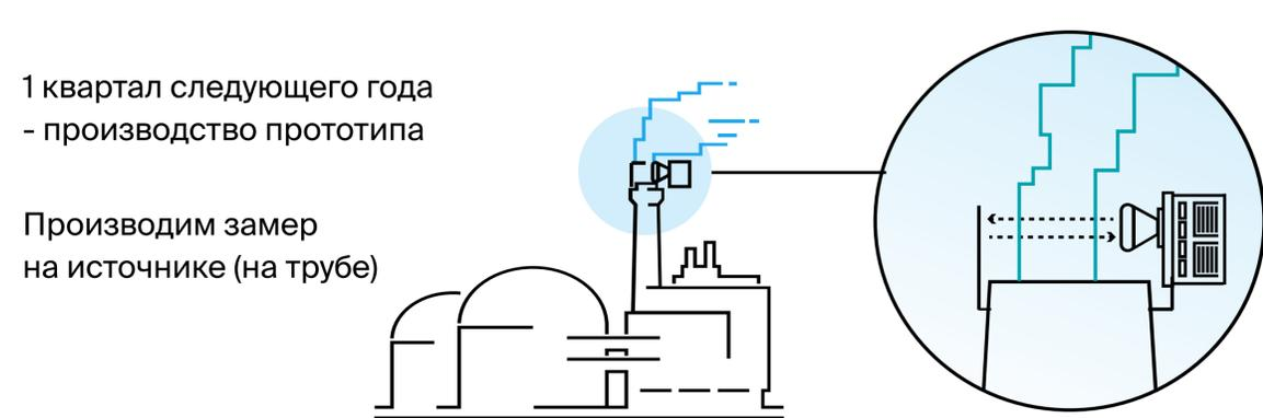
Инструментальные замеры выбросов углеродных единиц (в кг) и загрязняющих газов прибором, устанавливаемом на трубе.
