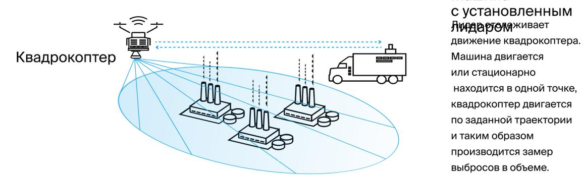
Инструментальные замеры поглощающей способности и выбросов углеродных единиц (в кг) связкой из двух установок: одна на машине, другая на дроне. Позволяет измерять потоки газов вокруг труднодоступных территорий.
